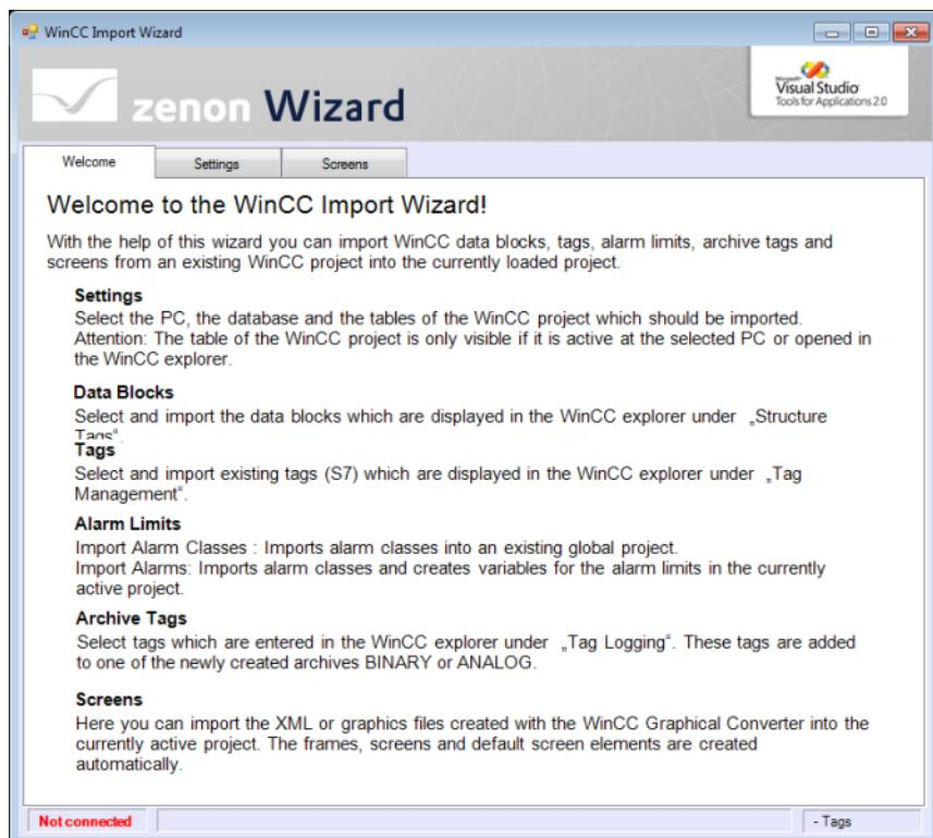
L'importation directe de données est uniquement possible lorsque vous avez configuré la connexion au projet WinCC dans l'onglet **Settings** (Paramètres).
