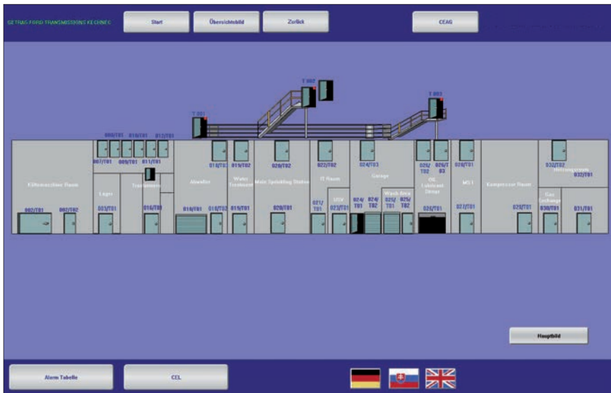
zenon visualisiert und überwacht die Türen des Gebäudekomplexes sowie die Beleuchtungsregelung und die Jalousiesteuerung.
