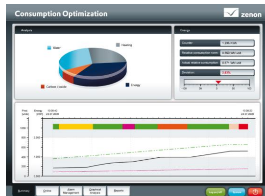
Abbildung 1: zenon berechnet und präsentiert die Energy Performance Indicators (EPIs) in Echtzeit, in Korrelation mit Produktionsinformationen.
