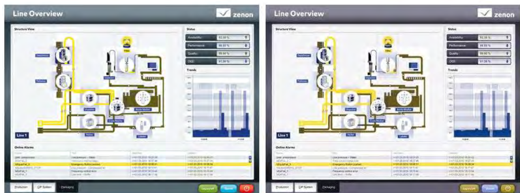
Abbildung 5: Originalbild mit zenon-Skin "Color Corrected" (links) und dadurch optimierte Deuteranopie-Wahrnehmung (simuliert, rechts)
