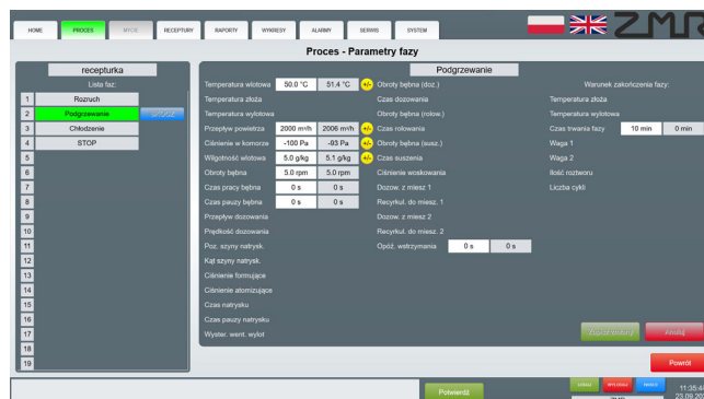
Edycja fazy „Podgrzewanie” w procesie powlekania tabletek wraz z dostępem i podglądem do faz poprzednich/następnych (Powlekarka/Drażownica D600/750Ex).
