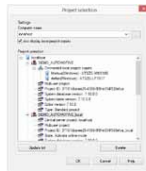
Abbildung 3: Anzeige des Serverprojekts, der lokalen Projektkopien und der verbundenen Benutzer, die über diesen Dialog auch entfernt werden können.
