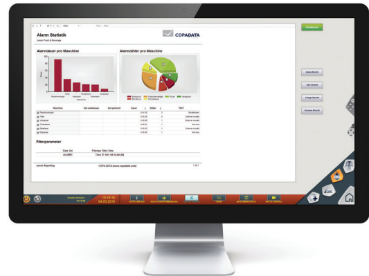
Abbildung 1: Beispiel eines F&B Alarm-Reports in zenon. Das Balkendiagramm auf der linken Seite gibt Auskunft über die Alarmdauer pro Maschine, das Tortendiagramm rechts zeigt die Anzahl der Alarme pro Maschine.
