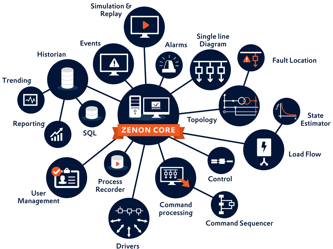
Abbildung 1: Einige relevante zenon Module, mit denen ein Verteilnetzsystem für kleine bis mittlere Stadtwerke gesteuert und überwacht werden kann.
