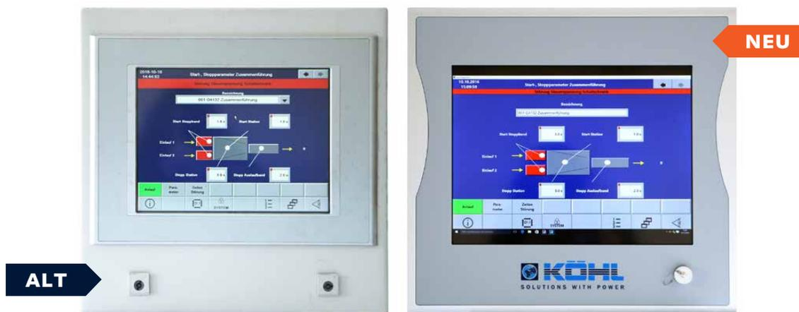
Die Modernisierung alter Panel an bestehenden Maschinen ist durch K-Retrofit und zenon mit geringem Aufwand möglich.
