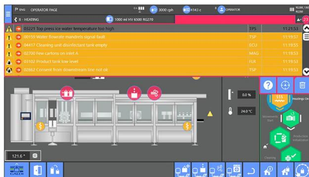
Im Falle eines Alarms haben die Bediener Zugang zu einer Reihe fortschrittlicher Diagnosefunktionen, die eine einfache Fehlererkennung ermöglichen und so Stillstandszeiten reduzieren.
