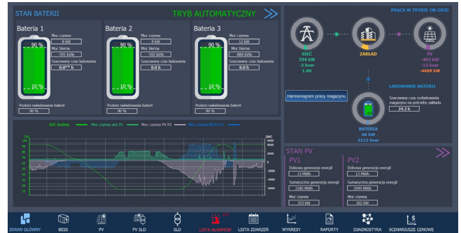
Ein Screenshot der Bedienerkonsole des Energiemanagementsystems zeigt den Betriebsstatus von Speicher und PV-Park.
