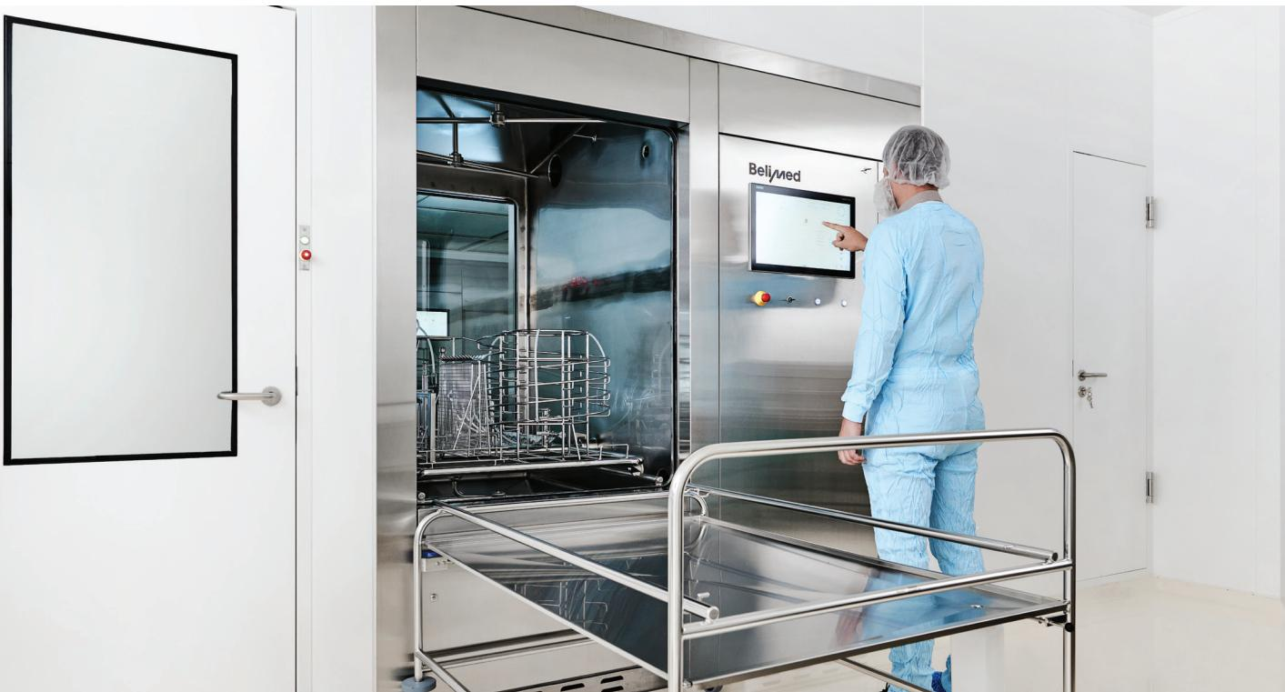
Keimfreiheit ist in der Arzneimittelherstellung unerlässlich: Maschinenteile, Behälter oder Verpackungen müssen vor jedem Gebrauch sterilisiert werden. Dies erfolgt meist unter Druck mit Dampf in sogenannten Sterilisatoren; diese werden beispielsweise in der pharmazeutischen Industrie bei Arzneimitteln und deren Primärverpackungen angewendet. Um den regulatorischen Auflagen zu genügen, müssen die Sterilisatoren die vermehrungsfähigen Mikroorganismen eliminieren.
