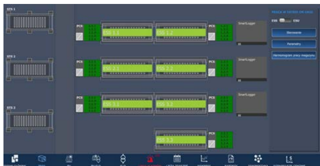
Ekran systemu EMS przedstawiający podgląd i status pracy trzech sekcji magazynów energii (ESS) wraz z konwerterami mocy (PCS) w trybie on-grid.
